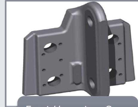
Entwicklung eines Guss-Klappgelenkes
